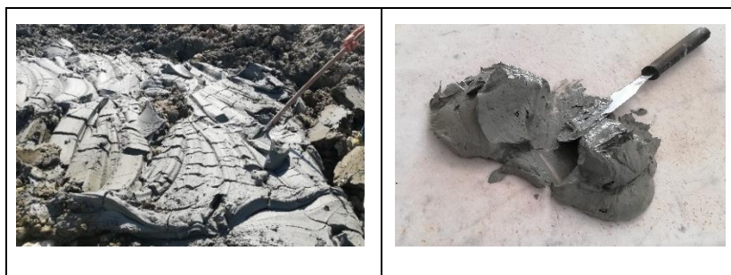
Fig. 2 Sedimento di dragaggio durante il prelievo e in laboratorio
