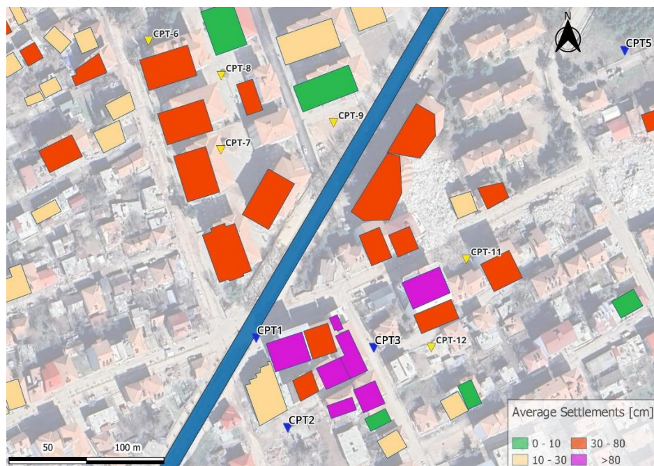
Fig. 3 Risultato in GIS della ricognizione. Mappa di parte dell'area ispezionata con l'indicazione dei cedimenti medi degli edifici investigati
